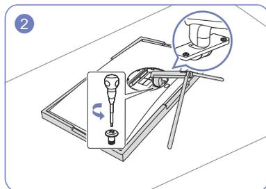
Afloje los 2 tornillos de la parte inferior del mástil del soporte.
