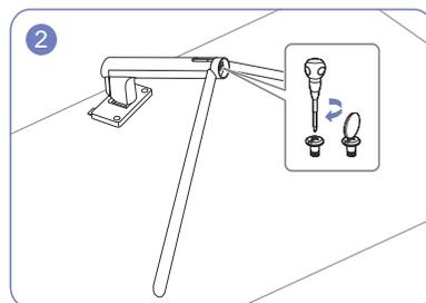
Gire completamente el tornillo de conexión en la parte inferior del soporte para que quede firmemente sujeto.
