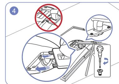
Apriete los tornillos de la parte inferior del mástil del soporte.
