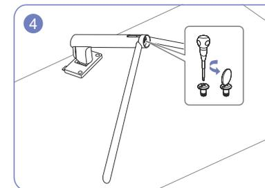
Extraiga el conector del soporte del soporte tirando de él en la dirección de la flecha, como se muestra en la ilustración.
