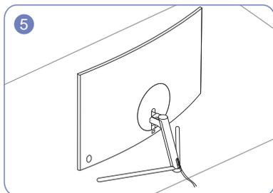
Una vez conectados, coloque correctamente la fuente de alimentación y el cable de datos y vuelva a poner la PARTE AUXILIAR DE LA CUBIERTA TRASERA, como se muestra en la ilustración.
