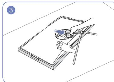
Levante y retire el soporte en la dirección de la flecha, como se muestra en la ilustración.
