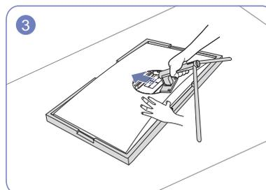
Coloque en el suelo el acolchado protector de poliestireno extrusionado (Styrofoam) incluido en el paquete y, a continuación, coloque el producto boca abajo sobre el protector, como se muestra en la imagen. Si no dispone del protector de Styrofoam, use una esterilla gruesa.
