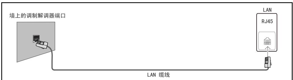
如果您拥有动态网络，则应使用支持动态主机配置协议 (DHCP) 的 ADSL 调制解调器或路由器。支持 DHCP 的调制解调器和路由器可为您的产品自动提供用于访问 Internet 的 IP 地址、子网掩码、网关和 DNS 值，因此无需手动输入它们。大多数家庭网络都是动态网络。
