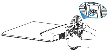
2. 松开底座支撑臂螺丝，从显示器上卸下底座。
