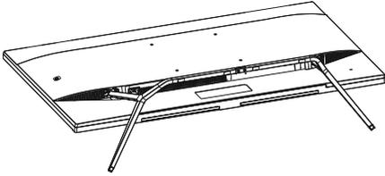
2. Afloje los tornillos del ensamblaje y, a continuación, desmonte las bases de la pantalla.
