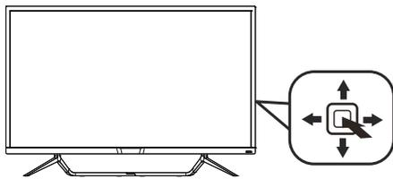
Para acceder al menú OSD de esta pantalla Philips simplemente tiene que utilizar el botón de cambio único situado en la parte posterior del marco de la pantalla. El botón único opera como un joystick. Para mover el cursor, simplemente accione el botón en cuatro direcciones. Presione el botón para seleccionar la opción que desee.
