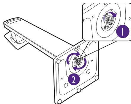
Oriento y alinee el enchufe el brazo de soporte con el monitor (1) y presione uno con otro hasta que haga clic y encajen (2).
