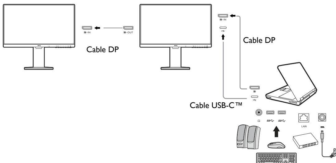
1. Conecte su portátil al puerto USB-C™ / DP del monitor a través de un cable USB-C™ / DP. Seleccione **SI** para habilitar la entrega de alimentación USB-C™ en el modo de espera del monitor si así se le pide. El puerto USB-C™ suministra alimentación al portátil incluso cuando el monitor esté en modo de espera.
