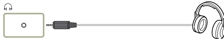
— El conector para auriculares solo admite dispositivos de tipo TRS (punta, anilla, manguito) de 3 conductores.
