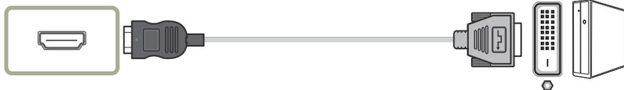
— La función de audio no se admite si el dispositivo fuente está conectado mediante el cable HDMI-DVI.
