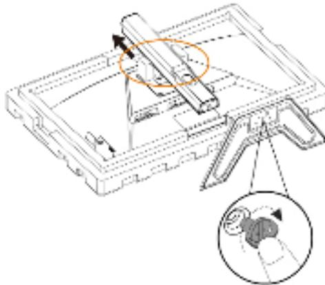
3. Levante el monitor a una posición vertical y colóquelo sobre una mesa. La altura del monitor puede ajustarse después de que se retiren los elementos 1 y 2 que se muestran en la figura.
