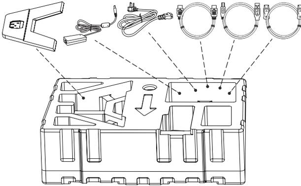
6. Retire la espuma superior de EPS. A continuación, puede quitar el monitor de la espuma de EPS inferior.
