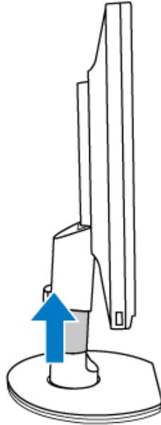
**(b)** Ponga el monitor boca abajo en una superficie lisa, teniendo cuidado de evitar rayar o dañar la pantalla. Luego levante el soporte del monitor.
