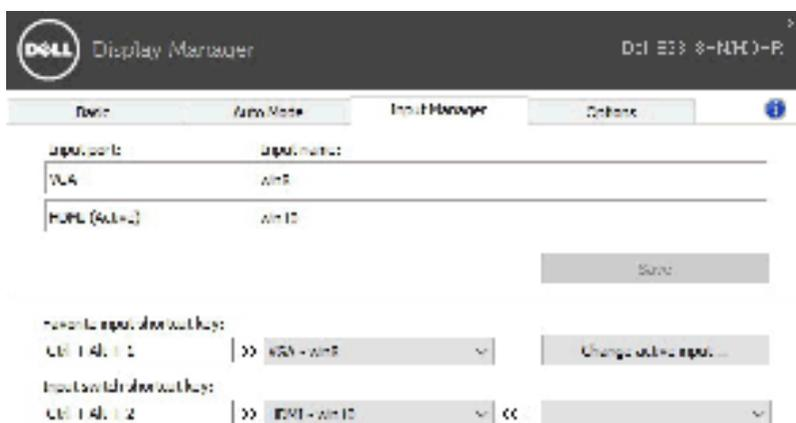
Puede utilizar la lista desplegable para cambiar a cualquier fuente de entrada.
