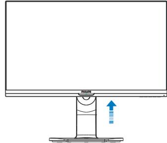
2. Coloque el monitor bocabajo sobre una superficie suave. Extreme la precaución para evitar arañar o dañar la pantalla. A continuación, levante el soporte del monitor.
