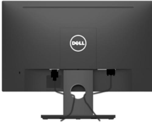
Una vez conectados todos los cables necesarios al monitor y al PC (consulte la sección Conectar el monitor para obtener más información sobre la conexión de los cables), organícelos como muestra la ilustración anterior.
