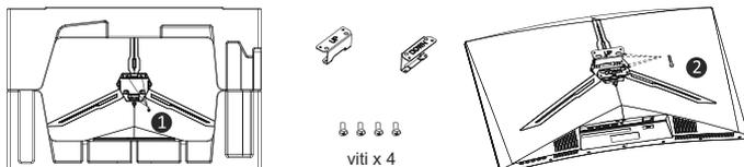
3. Il monitor è ora pronto per essere fissato a una staffa di montaggio a parete. Durante il processo d'installazione della staffa non stringere lo schermo con la mano per evitarne il danneggiamento.
