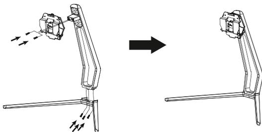
3. Come mostrato nelle immagini seguenti, spingere verticalmente il gancio della serratura. Inserire le parti assemblate dello stand nella fessura posta sul retro e bloccarle meccanicamente. Tenere il centro del supporto e assicurarsi che il monitor non si spenga.
