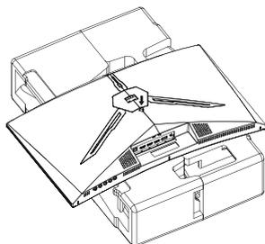
2. Bloccare i componenti dello stand e la staffa con due viti PM4\*10 mm, quindi bloccare la base con le tre viti PM4\*10mm.
