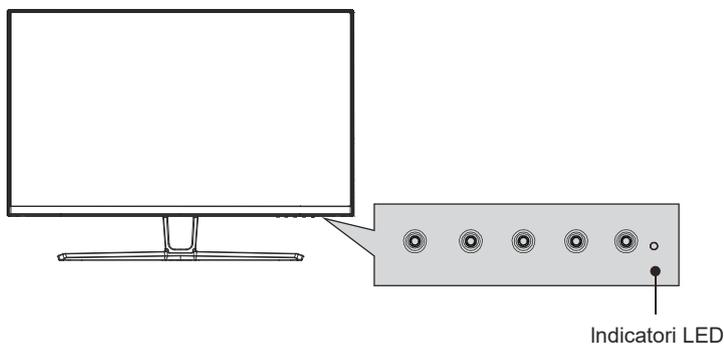
La luce blu fissa indica che l'alimentazione è accesa e il monitor funziona normalmente. La luce blu lampeggiante indica che non è stata rilevata alcuna sorgente video, non è stato rilevato alcun segnale orizzontale / verticale o la tensione è bassa. Assicurati che il computer sia acceso e che tutti i cavi video siano completamente collegati.
