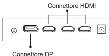
3. Collegare il cavo di alimentazione al monitor, quindi collegare l'altra estremità alla fonte di alimentazione. Si consiglia di utilizzare un dispositivo di protezione da sovratensione adeguato se la presa a muro ne è sprovvista.
