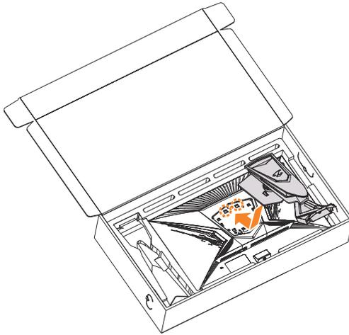
3. Alinee la base del soporte con el soporte debajo de la parte inferior. A continuación, conecte la base al soporte.
