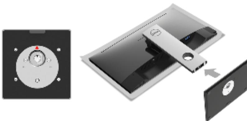
**5** Inserte los bloques de la base de soporte completamente en la ranura del soporte.
