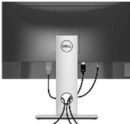
Después de conectar todos los cables necesarios al monitor y al PC, (consulte [Conexiones del monitor](#) para conectar los cables), utilice la ranura de sujeción de cables para organizarlos correctamente tal y como se muestra arriba.
