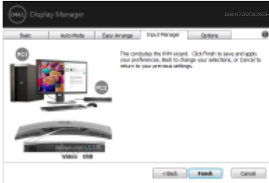
**NOTA:** DDM se comunica con el Pantalla incluso cuando este muestra vídeo de otro equipo. Puede instalar DDM en el equipo que utilice frecuentemente y controlar el cambio de entradas desde él. También puede instalar DDM en otros equipos conectados al Pantalla.
