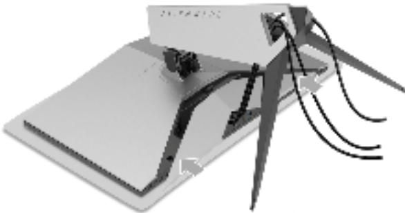
**NOTA:** Compruebe que los cables pueden pasar a través de la parte inferior de la cubierta del cable.
