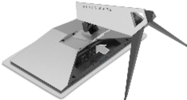
3. Enrute y conecte los cables necesarios al monitor, como aparece en la ilustración.
